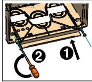
Mettre en place les ergots de la plinthe dans le socle puis basculer la plinthe ❸.
