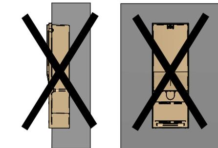
Afin que l'installation soit correcte, du jeu doit être présent entre la borne et les murs.
