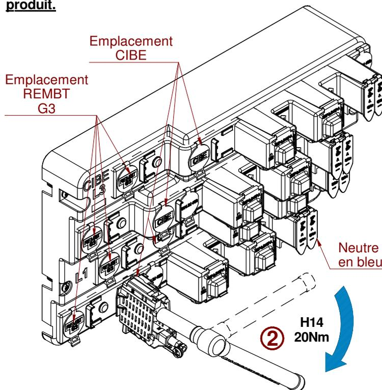
**Remarques :** ⚠ **REM/BT** Vérifier lors de la mise en place qu'il n'y ait pas d'interférence avec par exemple la serrure et la vis départ, sinon déplacer le produit en modifiant la configuration ou visser la vis départ.
